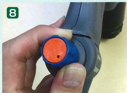
レギュレーターをゆっくり(5mm間隔) +方向へ徐々に上げていく
