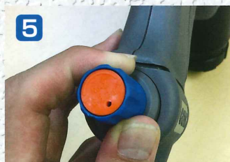
5 レギュレーターをゆっくり(5mm 施工間隔)で＋方向へ徐々に上げていく
