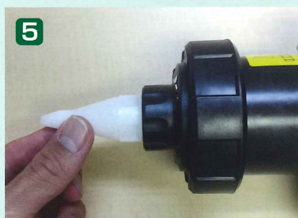
アウターノズルをねじ込み式で装着
