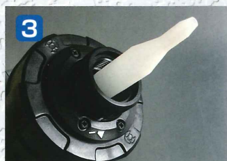
3 先端ダイヤルを1本線マークにセットする
