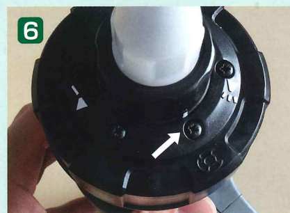
180度回転する先端ダイヤルを3本線マークから1ネジ目まで回転させる
