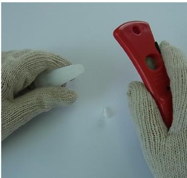
ノズルをカットできたら、カートリッジに再装填します。
