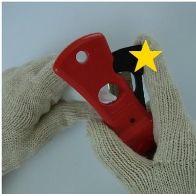
ノズルの先を施工部の大きさに合うよう刃の位置を調節します。★の部分で指で押しノズルカットします。
